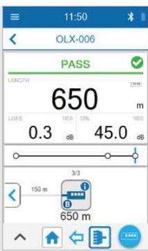
**5 Freischaltung und Fehlerdiagnose von außerhalb des Gebäudes aus. Test in Richtung Splitter:**
