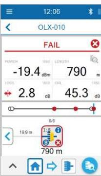
**4 Freischaltung und Fehlerdiagnose von außerhalb des Gebäudes aus. Test in Richtung ONT:**
